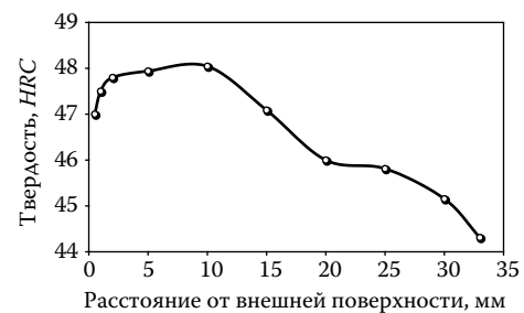
Рис. 1. Распределение твердости по сечению в центре детали из кремнистой стали после охлаждения в закалочном масле И-20А от температуры 925\text{ }^{\circ}\text{C} (до проведения аудита участка термической обработки)
