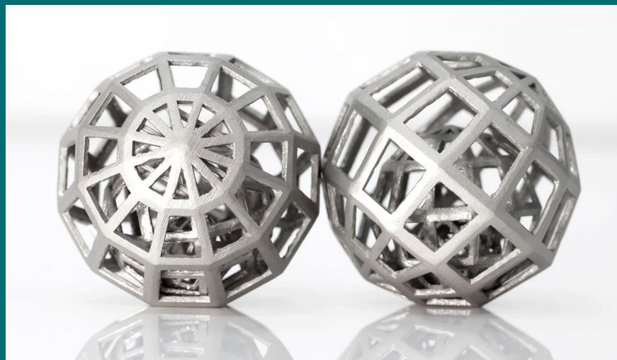
Аддитивные технологии позволяют послойно “выращивать” детали с очень сложной внутренней структурой.
