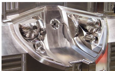
Рис. 2. Формообразующие поверхности инструментальной оснастки часто содержат большое количество симметрично расположенных элементов.
