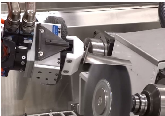
В процессе полирования лопатка перемещается относительно неподвижного инструмента.
