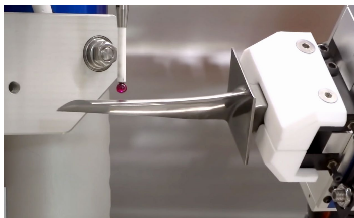
В процессе измерений промышленный робот «подносит» деталь к неподвижно установленному измерительному щупу.
