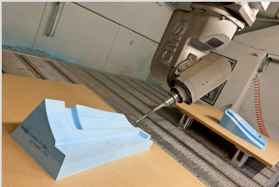
Фирма Pentaxia использует CAM-систему PowerMILL для программирования всего парка пятиосевых фрезерных станков с ЧПУ, в том числе, марки CMS.
