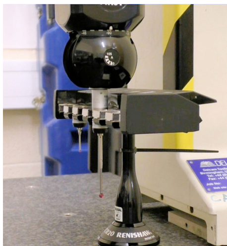
В PowerINSPECT реализована поддержка широко распространенных моделей стоек: MCR20 и FCR25 фирмы Renishaw.
