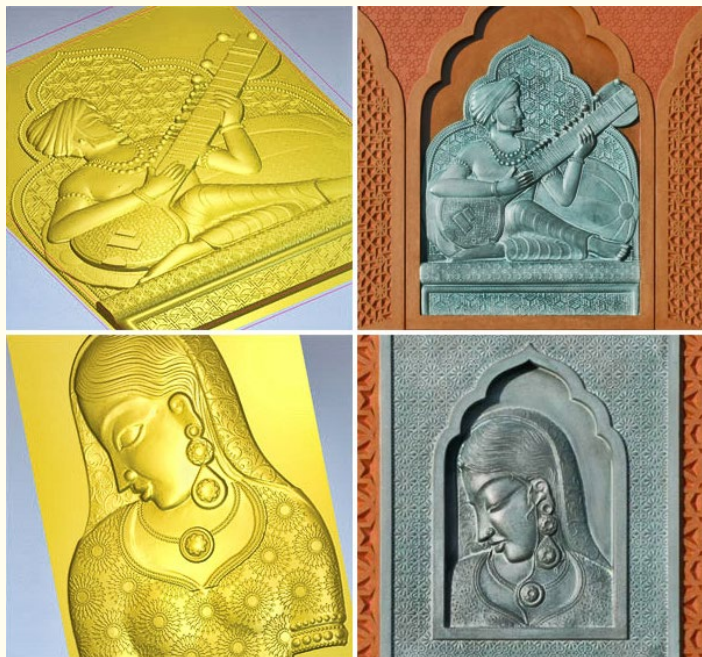
CAD/CAM-система ArtCAM дает возможность легко создавать 3D-рельефы с периодически повторяющейся структурой, например орнаменты, текстуру одежды, украшения и т.д.
