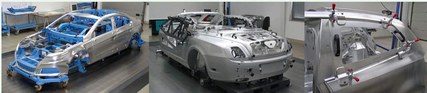
Эталонная модель (габаритный макет «cube») кузова автомобиля используется для установки на нее различных вариантов съемных конструктивных элементов с целью проверки равномерности зазоров и точности сопряжения поверхностей.
