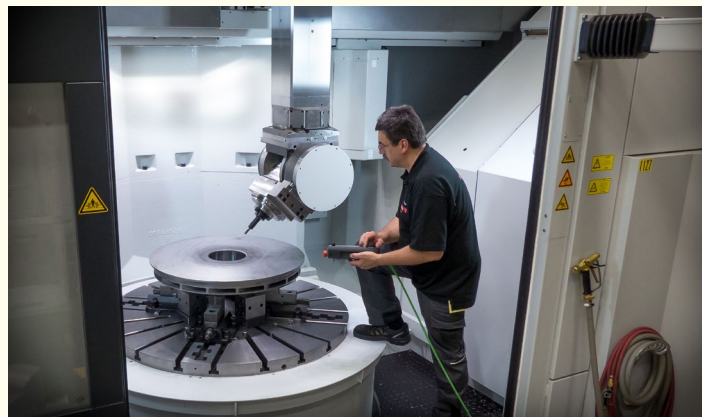
Рис. 4. Оператор станка Starrag Group Dorries VCE 1600/140 MC VMT в процессе установки и базирования детали на рабочем столе.
