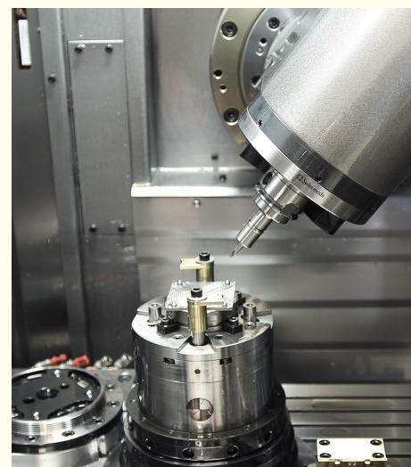
Рис. 5. Компактный VMT-станок Bumatex S191V предназначен для обработки небольших деталей.
