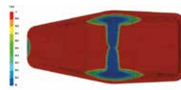
Распределение степени полимеризации в конце пропитки авиационного изделия
