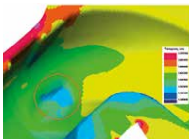
Распределение поле толщины металла после оптимизации процесса, мм
