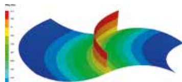
Время пропитки 21.3, оболочечная модель
