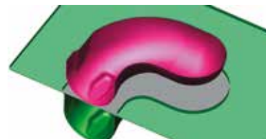
Подготовленная геометрия для моделирования штамповки изделия
