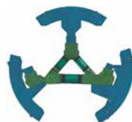
Сварочная КЭ модель дивертора
