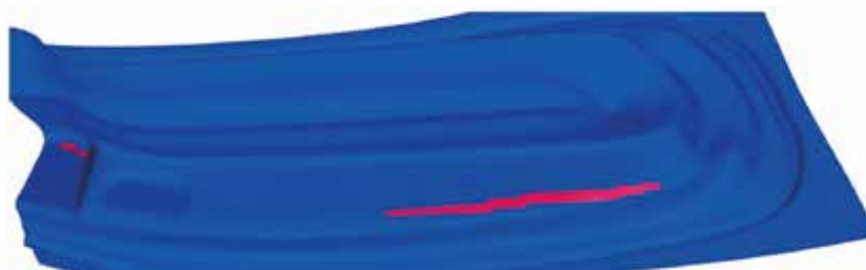
Образование трещин при штамповке (моделирование процесса)
