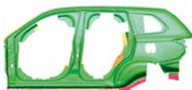
Качественный анализ состояния поверхности панели по диаграмме предельной формоустойчивости
