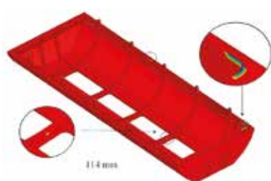
Выявление дефектов для примененной схемы вакуумирования, также обнаруженные во время реальной пропитки
