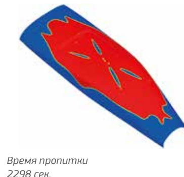
Схема расположения вакуумных портов, PAM-RTM. Группа 1 – порты подачи связующего
