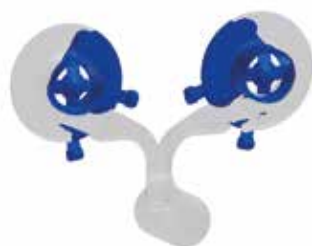
Эвакуация воздуха (синий цвет) из формы при заливке; выявление закрытых воздушных участков
