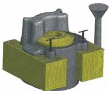
Расчетная конечно-элементная сетка отливки «Букса» (форма модели скрыта)
