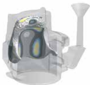
Образование локальных жидких участков при кристаллизации отливки (слева) и конечное распределение усадочных дефектов (справа)
