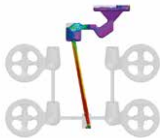
Скорость потока в начальной стадии заполнения для исходной (слева) и оптимизированной технологии (справа)
