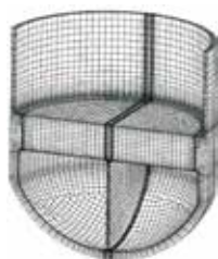
Вварка стенки в корпус парогенератора, где: а – КЭ модель части корпуса со стенкой; б – Остаточные напряжения после сварки
