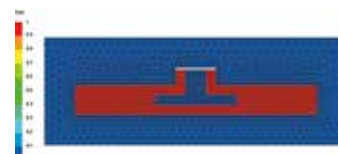
Расчет в модуле Curing. Полимеризация изделия
