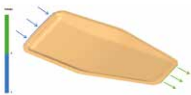
Схема 1. Подача и отвод связующего с торцов детали. Граничные условия: Группа 1 - подача связующего, Группа 2 - отвод связующего
