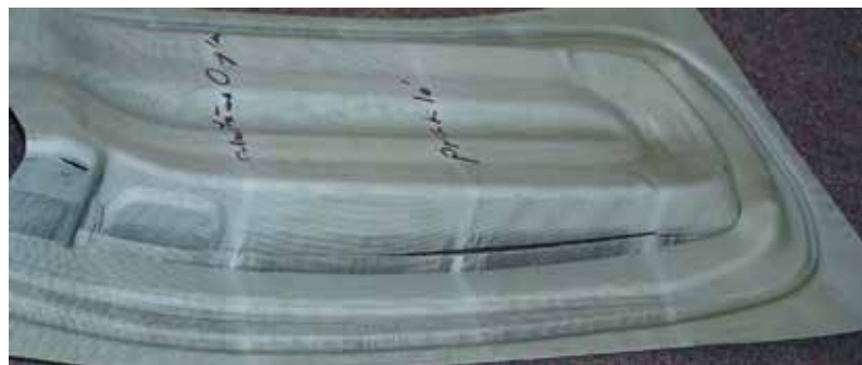
Образование трещин при штамповке (реальное изделие)
