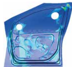
Результаты расчета сваренных заготовок: поле распределения первого главного напряжения, ГПа
