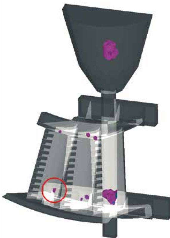
Усадочные дефекты в отливке
