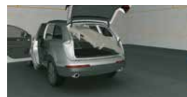
Проверка демонтажа обивки крыши (Audi)
