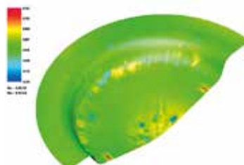
Пружинение в изделии после компенсации
