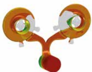
Заполнение формы с распределением температуры металла
