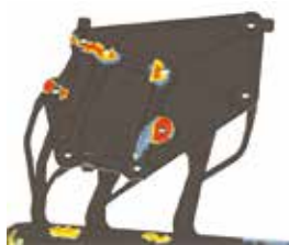
Распределение микро пористости в отливке (литье под давлением)
