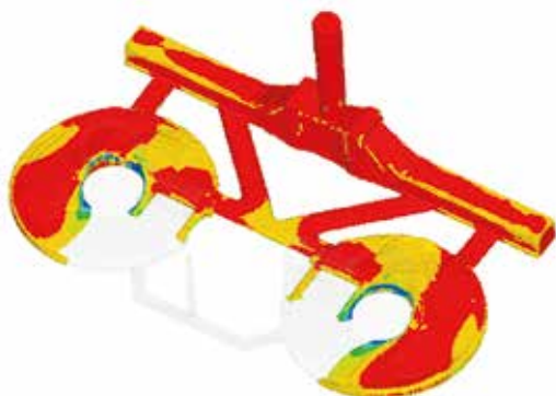
Заполнение формы сплавом с распределением температуры потока
