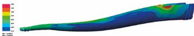
Пружинение в боковой части
