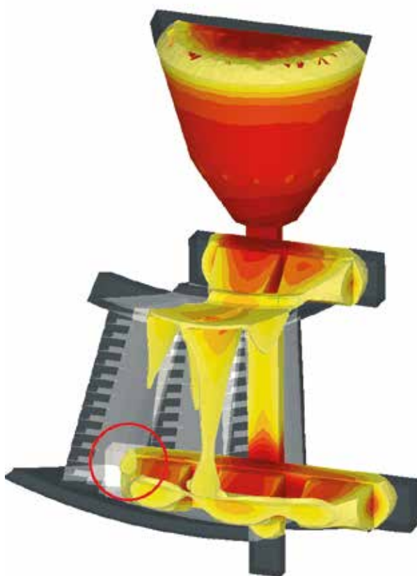
Кристаллизация сплава и образование тепловых узлов в отливке
