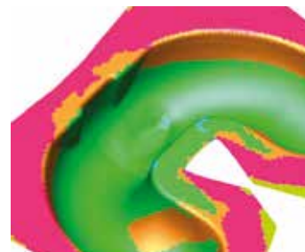
Качественный анализ состояния поверхности изделия после штамповки в соответствии с диаграммой предельной формоустойчивости
