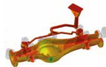
Заполнение формы сплавом с распределением температуры потока
