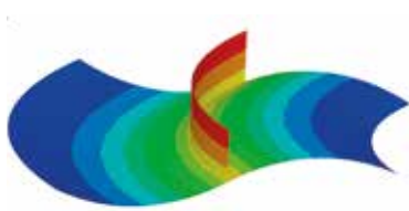
Оболочечная модель. Время пропитки 21.3 сек
