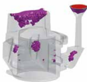
Образование локальных жидких участков при кристаллизации отливки (слева) и конечное распределение усадочных дефектов (справа)
