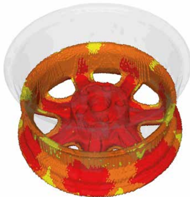
Заполнение формы сплавом с распределением температурного поля при литье под низким давлением
