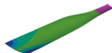
Оболочечная модель. Визуализация толщины ламината. Модуль DEX Process, Visual Environment
