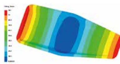
Схема 3. Точечная подача в центре детали, отвод с боковых торцов. Время пропитки изделия
