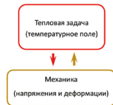
Схема расчета сварочных деформаций методом «усадки»
