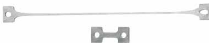
Удлинение заготовки в состоянии сверхпластичности
