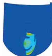
Вварка стенки в корпус парогенератора, где: а – КЭ модель части корпуса со стенкой; б – Остаточные напряжения после сварки
