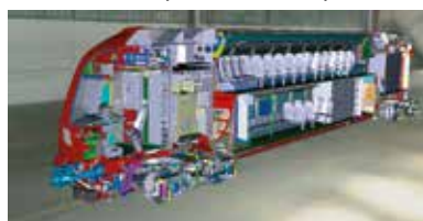
Продольное сечение полной сборки поезда (Bombardier Transportation)
