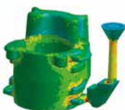
Распределение средних нормальных напряжений в отливке (слева) и деформация отливки от первоначального положения (увеличено в 5 раз) (справа)
