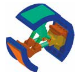
Общие перемещения после сварки
