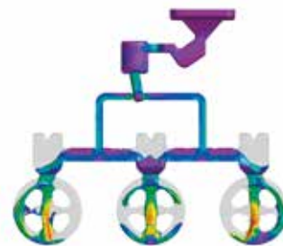
Скорость потока в начальной стадии заполнения для исходной (слева) и оптимизированной технологии (справа)
