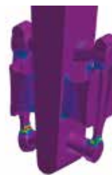
Места образования горячих трещин в отливке
