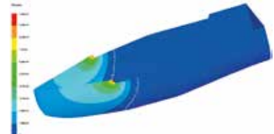
Распределение давления после достижения смолы сенсора S1
