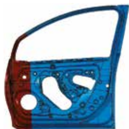
Применение составных сваренных заготовок: красная часть имеет толщину материала 1,3 мм, синяя – 0,7 мм
