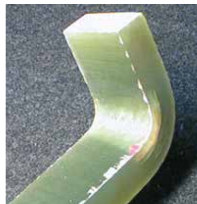
Коробление композитного изделия
