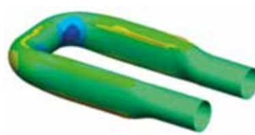
Гидроформовка трубы, рассчитанная в AUTOSTAMP
