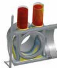
Кристаллизация отливки в форме
