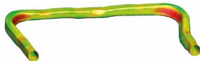
Труба, полученная гидроформовкой
