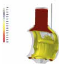
Распределение усадочных дефектов в отливке
