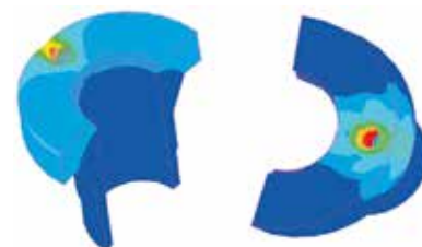
Остаточные напряжения после ремонта резьбового соединения
