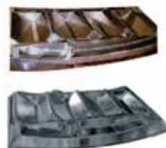
Изготовление методом сверхпластической формовки двери-трапа самолета вместо сваренной из 23 частей
