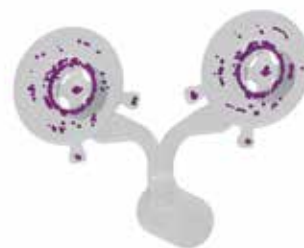
Распределение усадочных дефектов в теле отливки
