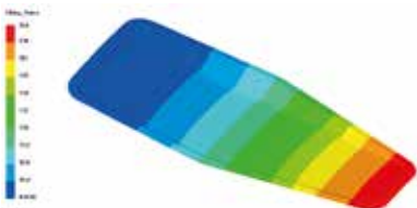
Схема 1. Подача и отвод связующего с торцов детали. Время пропитки изделия
