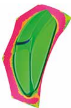
Качественный анализ состояния поверхности по диаграмме предельной формоустойчивости
