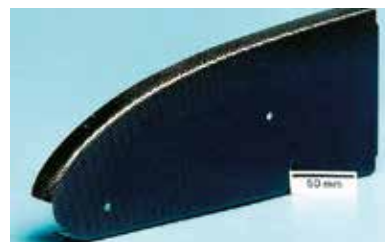
Авиационная деталь, изготовленная методом формовки с помощью мембран
