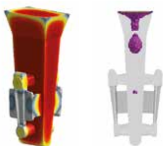
Кристаллизация отливки и распределение усадочных дефектов
