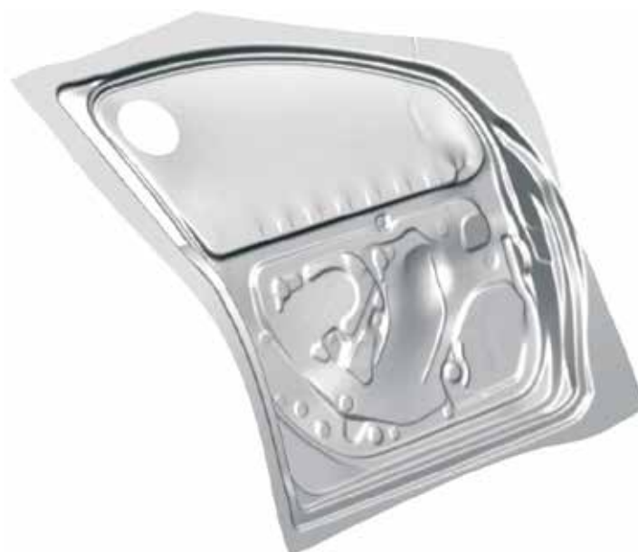
Формовка изделия полиуретановым пуансоном
