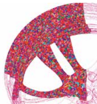
Зеренная структура отливки автомобильного колеса
