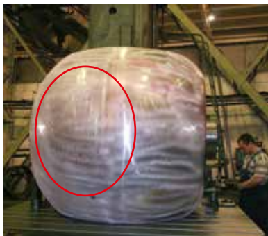
Выявленные зоны усадочных рыхлотов после проведения дефектоскопии
