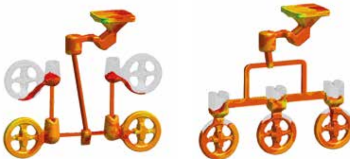
Заполнение формы сплавом при исходной (слева) и оптимизированной технологии (справа)
